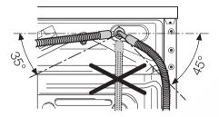
3. Отрегулируйте положение шланга, ослабив зажимную гайку. Отрегулировав положение шланга, не забудьте плотно затянуть зажимную гайку для предотвращения утечек.
