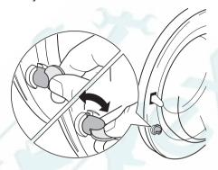
Для отключения этого устройства, чтобы снова можно было закрыть дверцу, поверните кнопку против часовой стрелки так, чтобы паз оказался в вертикальном положении.
